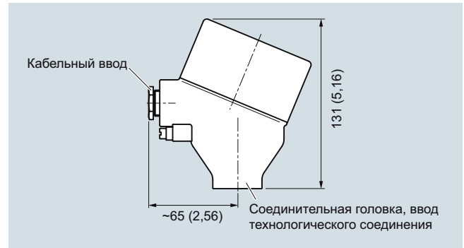
Соединительная головка с дисплеем и стеклянной крышкой, алюминий, тип AH0, нержавеющая сталь, тип AV0, размеры в мм (дюймах)
